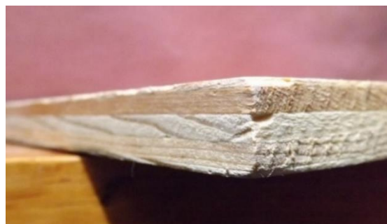
Figura 2. Ejemplo de la estructura por capas que conforman el contrachapado. Fuente fotográfica; Gutiérrez, Anabel (2020)
