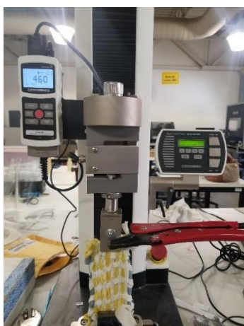
Figura 12. Prueba de tejido con fibras nuevas.
