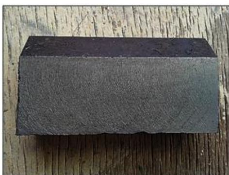
Figura 6. Muestra M-1. Probeta de acero G10350 con superficie fresada.
