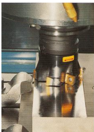
Figura 14. Planeado de placas de acero con fresa de 90°.
