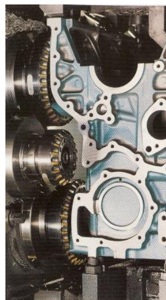
Figura 13. Planeado de una pieza de fundición con fresa de 45°.
