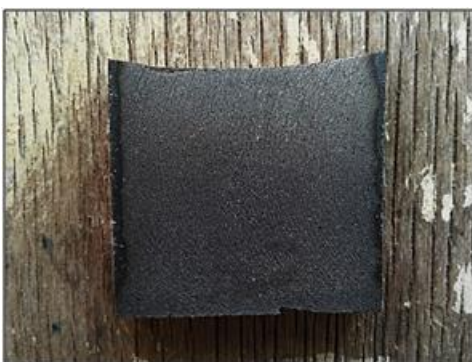
Figura 7. Muestra M-2. Probeta de fundición gris F10009 con superficie fresada.
